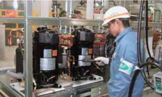
Máy nén được phát triển và sản xuất bởi Mitsubishi Electric* Quy trình kiểm tra sự rò rỉ của môi chất lạnh bằng cách sử dụng khí Heli *Áp dụng cho dòng sản phẩm CITY MULTI
