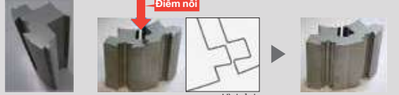
Hình 2: Cấu tạo lõi sắt
