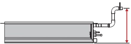
PEFY-P VMA-E4 tích hợp bơm nước ngưng
